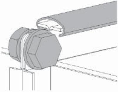
К воздуховодам вентилятор монтируется болтами и С-профилем.
