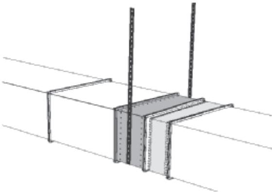
Если используются гибкие соединения, необходимо дополнительно прикрепить вентилятор к полу, стене или потолку.
