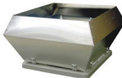
**Конструкция:** Корпус DVC выполнен из алюминия. Рама изготовлена из оцинкованной стали с защитным порошковым покрытием. Рабочее колесо вентиляторов типоразмеров 190 и 315 изготовлено из полиамида PA6. У DVC 355-630 рабочее колесо выполнено из алюминия в морском исполнении. Вентиляторы серии DVC имеют вертикальный выброс воздуха.
