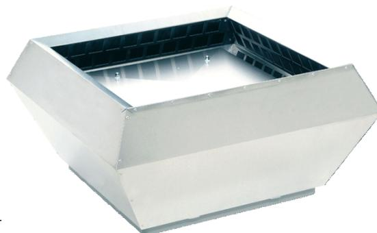
**Двигатель:** Вентиляторы DVCI-S оборудованы ЕС-двигателями постоянного тока с внешним ротором и встроенным устройством управления производительностью. Электродвигатели с рабочим колесом с загнутыми назад лопатками начиная с типоразмера 355 монтируются на высокоэффективных виброизоляторах. Двигатели оснащены электронной системой защиты от перегрева электродвигателя, дополнительные устройства защиты от перегрева не требуются.
